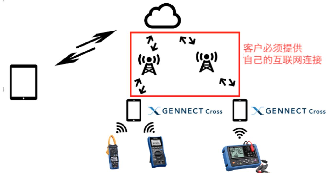
※GENNECT Cloud Free (免费) 可用于最多三个注册的应用程序和最多三个测量仪器连接到一个应用程序。
